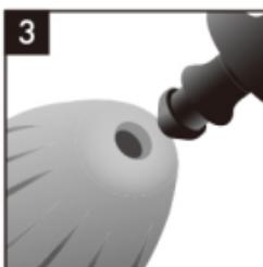
ノズルのフランジ部分(円筒形のディスク部)を持ち、バルブを絞らないようにして開け口へゆっくり、しっかり挿入します。ノズルの挿入が完了すると「パチッ」と音がします。
