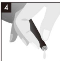
「アネロスプレリュード」を振るようにして、ノズルおよびバルブ内をよく洗浄します。中の部分がきれいになるまでこの動作を繰り返します。洗浄が終了したらノズルとバルブを分離、よくすすぎ、風通りのいい場所で乾燥させます。
